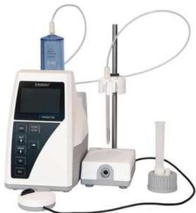
La TITRONIC® 300 es una bureta de pistón accionada por motor perfecta para la titulación manual y, al mismo tiempo, un dispositivo de dosificación de alta precisión para todos los líquidos de dosificación, disolventes y tituladores. El TITRONIC® 300 puede operarse como un dispositivo independiente y también puede controlarse mediante una PC/software o un valorador TitroLine®.
