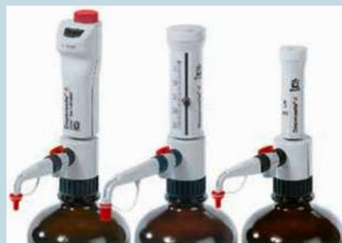
**Dispensette® S** ofrece un amplio espectro de aplicaciones para dosificación de reactivos agresivos directamente desde el frasco de reserva: p. ej. álcalis y ácidos concentrados, como  $H_3PO_4$ ,  $H_2SO_4$  (excepto p. ej.  $HCl$ ,  $HNO_3$  y  $HF$ ), soluciones salinas como también una gran cantidad de disolventes orgánicos.
