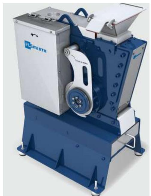
Cinco puntos de lubricación de fácil acceso que x 1421 mm requieren engrase cada 150 horas de funcionamiento
