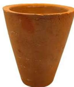
Crisol de porcelana 10 ml, diámetro exterior 31 mm, altura 26 mm COORS
