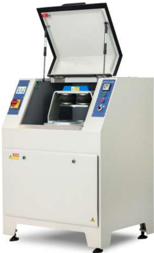
El RM2000 es confiable, seguro y robusto, diseñado para procesar muestras con un tamaño final de <75 micras. Con una construcción sólida y que requiere poco mantenimiento, el RM2000 viene con una operación de sujeción del cabezal con dos manos y un elevador neumático opcional para la ubicación asistida del cabezal durante la carga y descarga de cada muestra.
