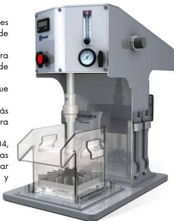
Control de velocidad variable con lectura digital de la velocidad de rotación del impulsor.
