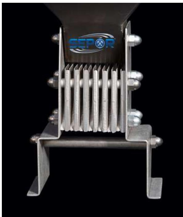
Muestreador rápido tipo Jones especialmente diseñado para mezclar materiales de grano moderadamente fino y obtener fracciones homogéneas.
