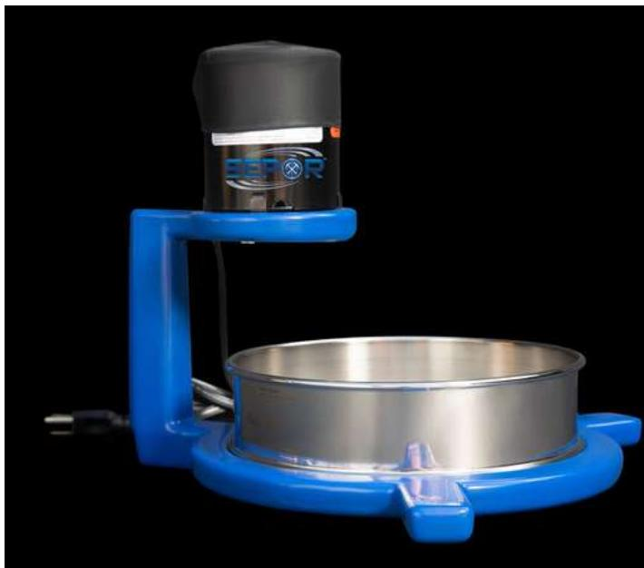
Aluminio fundido liviano, operado eléctricamente, portátil, diseñado para usar con uno o dos tamices de prueba de 8" de diámetro de altura completa o cuatro de media altura. Disponible en una versión de 12".
