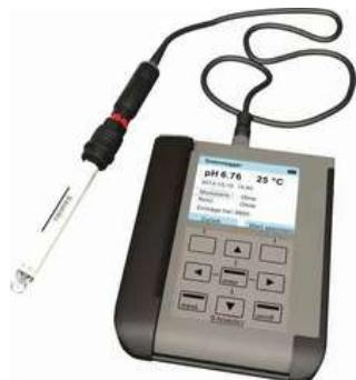
Con sensor Memosens® medición de pH, conductividad y oxígeno disuelto mediante un simple cambio de sensor
