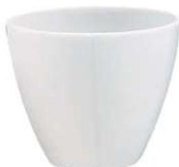
Crisol de porcelana 30 ml, diámetro exterior 43 mm, altura 37 mm COORS
